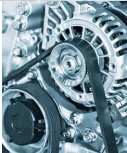
基于皮带驱动型启动发电机轻度混合动力车示例
