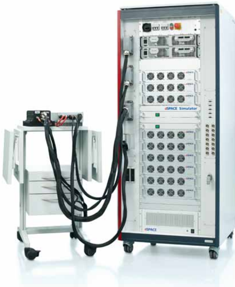
测试系统由一个 dSPACE 仿真器及其连接的 ECU 组成。
